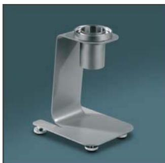
Вискозиметр — чашка Форда позволяет измерять вязкость согласно ISO 2431, ASTM D-1200
