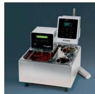
Цифровые погружные термостаты Thermovisc 100/200 для термостатирования образцов
