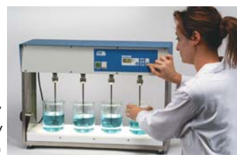
Флокулятор «Флокуматик» с подсветкой снизу (4 пробы)
