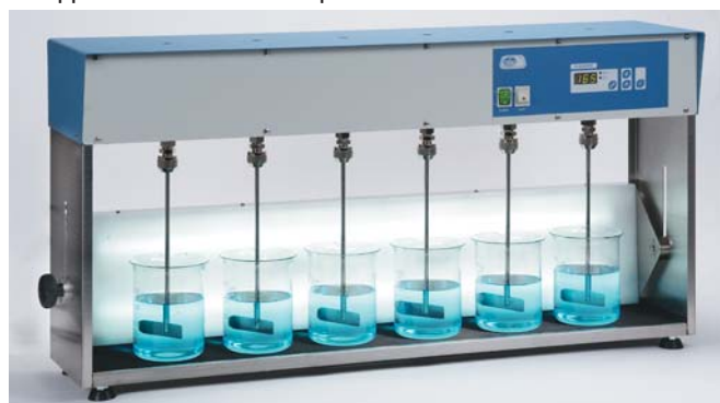
Флокулятор «Флокуматик» и подсветка сзади (6 проб)
