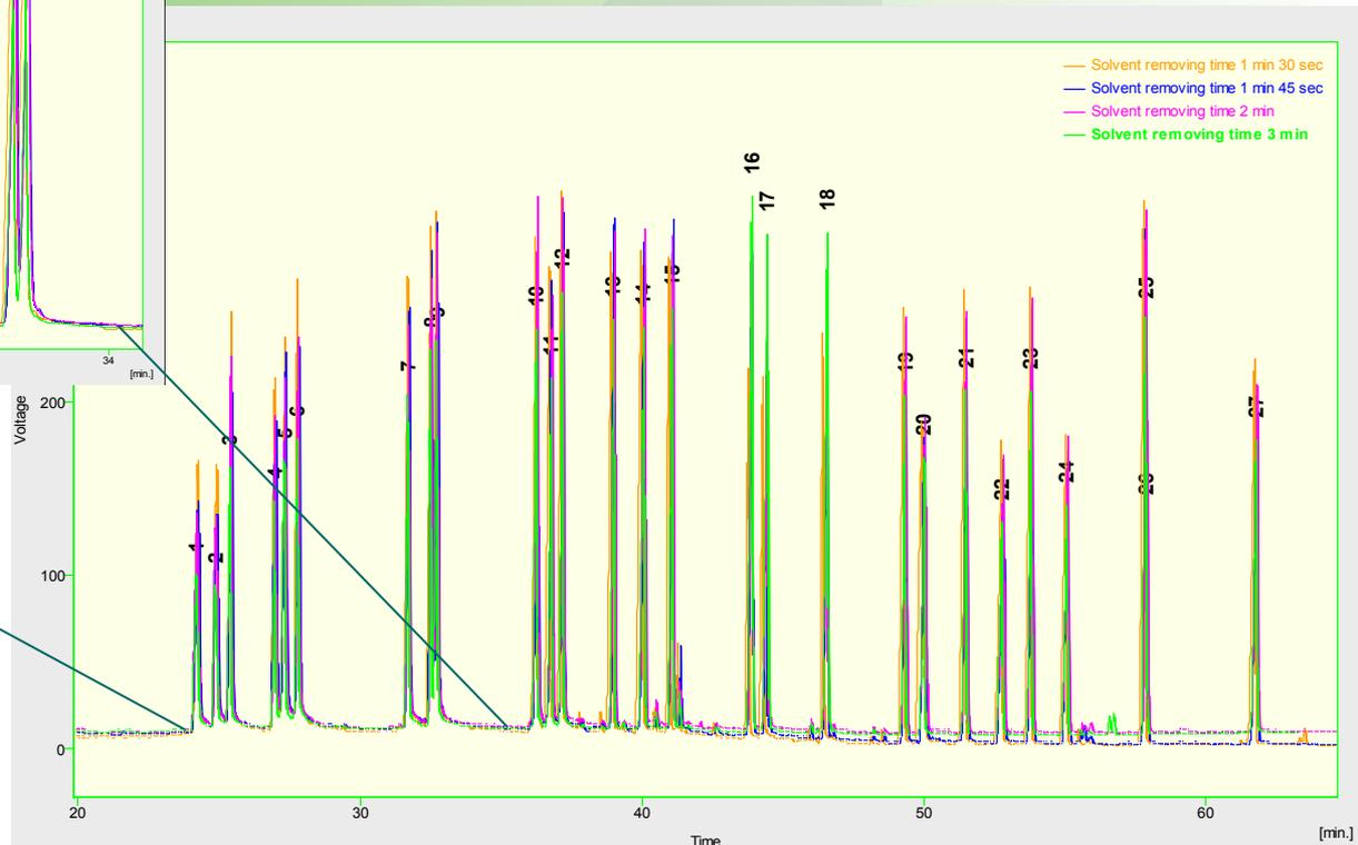
✓ Наилучший отклик для промежуточных компонентов (пики 16-18) получен при времени удаления растворителя 3 мин. Однако в целом сигналы, соответствующие наиболее и наименее летучим компонентам, значительно снижались при наибольшем времени удаления растворителя. Таким образом, растворитель удаляли через **1 мин 30 сек** после стадии переноса.
