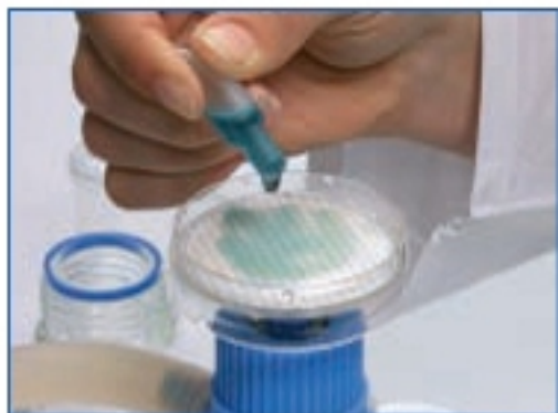
Рис. 3. Мембрана пропитывается питательной средой.
