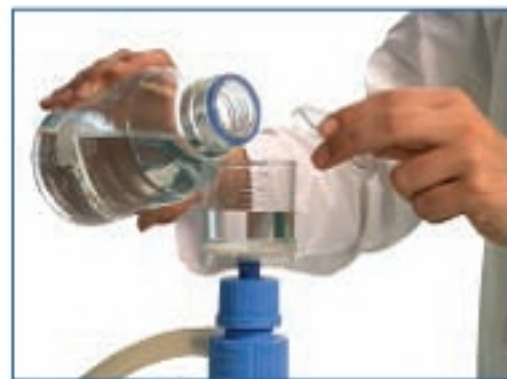
Рис. 1. Проба наливается в воронку и фильтруется.
