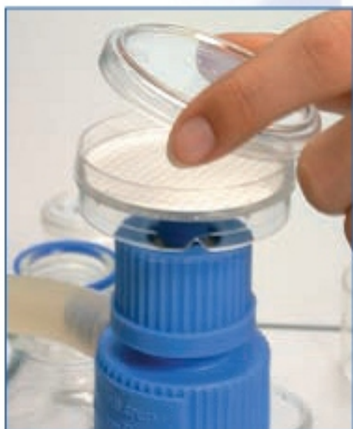
Рис. 4. Основание с мембраной закрывается крышкой, образуя чашку Петри
