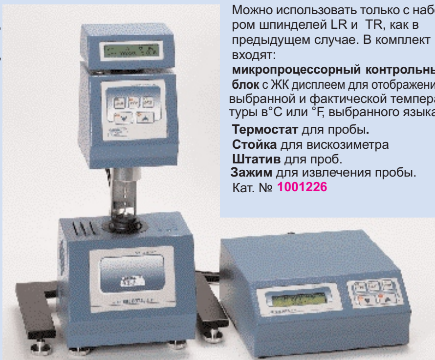
Электронный регулятор температуры ST-TEMP , соединенный с ST digit
