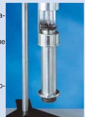
Адаптер для проб низкой вязкости без водяной рубашки. Кат. № 1001520.
